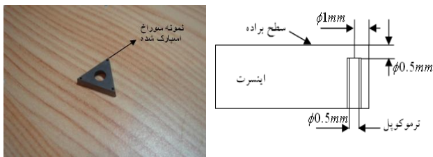
شکل (۶): موقعیت ترموکوپل و سوراخ ایجاد شده در ابزار
