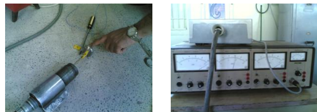
شکل (۵): دینامومتر حاوی سیستم اندازه گیری دما به همراه سنسور
