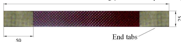
شکل (۶): آماده‌سازی نمونه‌های آزمایش کشش
