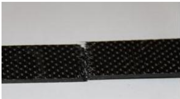
شکل (۱۲): فرایند شکست کششی در کامپوزیت فنولیک/الیاف کربن پس از اعمال ۵ دوره شوک حرارتی
