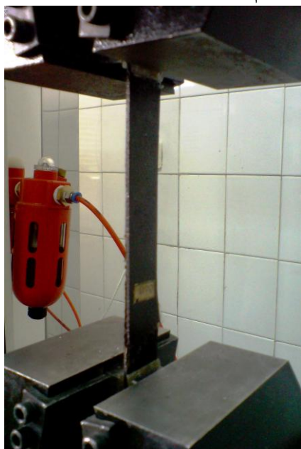
شکل (۷): نمونه کامپوزیتی در آزمایش کشش
