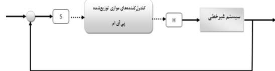
شکل (۶): نمای کلی سامانه کنترلی پیشنهادی
