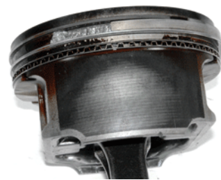
شکل (۱۷): پیستون آسیب دیده یک موتور بنزینی در ناحیه شیار
