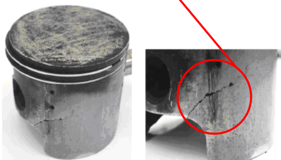
شکل (۱۵): پیستون آسیب دیده یک موتور بنزینی در ناحیه دامن پیستون [۱]
