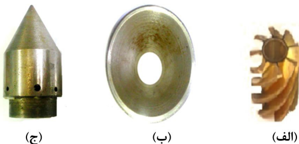
شکل ۳: قسمت های مشعل (الف) چرخاننده (ب) مخروط داخل تراش (ج) مخروط خارجی
