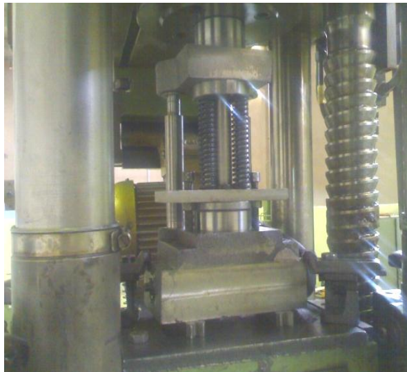
شکل (۱۱): قالب کشش عمیق مورد استفاده به همراه سیستم بادامک و پیرو
