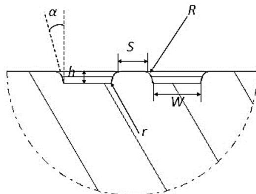
Fig. 2. Geometrical parameters of die
