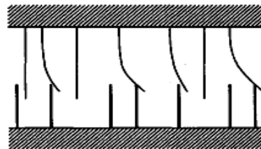
شکل (۶): چگونگی درگیری دندانها در حین لغزش دو سطح بر روی یکدیگر [۱۲]
