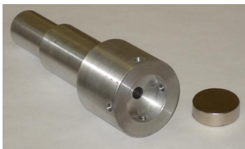
شکل (۴): نگهدارنده قطب N برای ایجاد حرکت دورانی
