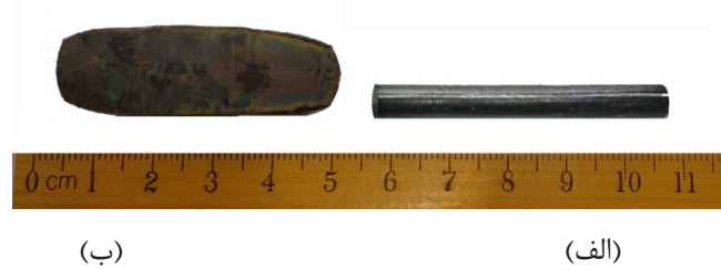
شکل ۶: (الف) تصویر میله آماده‌سازی شده جهت انجام آزمون فشار میله (ب) تصویر میله تغییر فرم یافته پس از خاتمه آزمون
