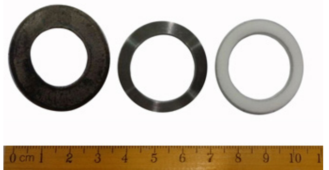
شکل ۴: (الف) حلقه آماده‌سازی شده جهت انجام آزمون فشار حلقه قبل و بعد از پوشش روانکار (ب) حلقه تغییر فرم یافته پس از آزمون فشار
