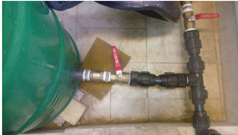
شکل ۳: شیر استفاده شده در مسیر ورودی Fig.3: Applied valve in the input path
