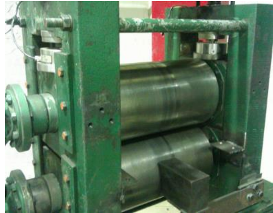
شکل ۳: نمایی از دستگاه فرآیند نورد تجمعی Fig. 3. The schematic of the ARB process
