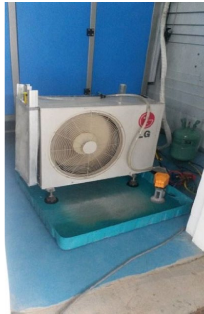
شکل ۳: تصویری سیستم لایه تبخیری و ملحقیات نصب شده در محل آزمایش
