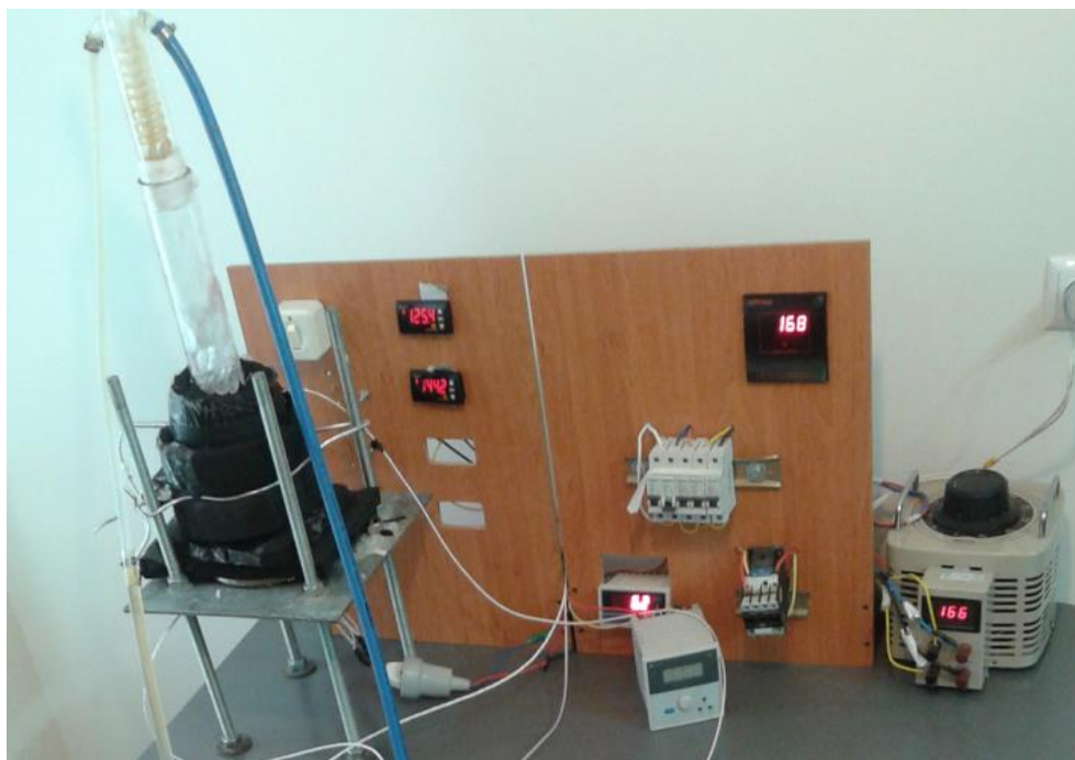
شکل ۳: تصویر واقعی دستگاه آزمایش جوشش
