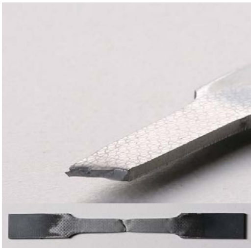
شکل ۵. شماتیک سطح و محل شکستگی نمونه تحت کشش Fig. 5. Schematic of surface and rupture zone of under tension sample
