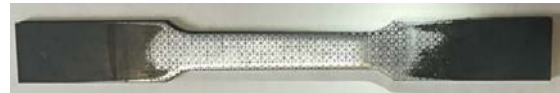
شکل ۳. نمونه کششی پس از عملیات سنباده‌زنی و الکترواچ Fig. 3. Tension sample after embossing and electroetch
