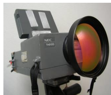
شکل ۲: تصویر دوربین حرارتی شرکت NEC مدل ۵۱۰۲TH استفاده شده توسط وانگ و همکاران [۱۳]
