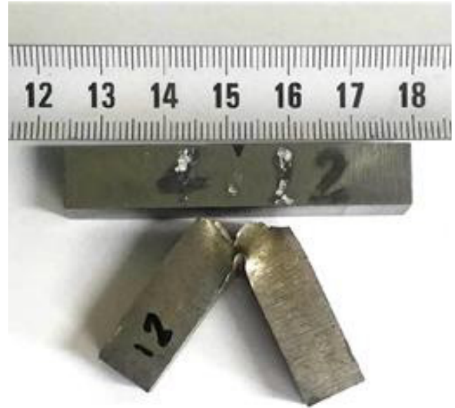
شکل ۵: نمونه با شعاع شیار استاندارد قبل و بعد از آزمایش ضربه شاری
