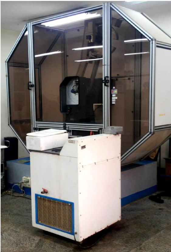
شکل ۴: دستگاه ضربه شاریبی با ظرفیت ۷۵۰ ژول
