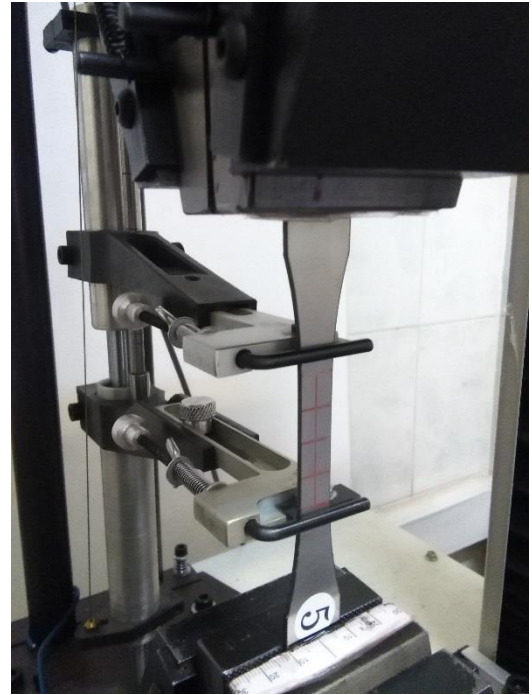
شکل ۱۲: نمونه تحت تست کشش در دستگاه سانتام اس.تی.ام-۲۰
