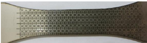
شکل ۵: نمونه نهایی گریدبندی شده با دستگاه الکتروا
