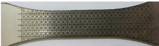
شکل ۵: نمونه نهایی گریدبندی شده با دستگاه الکترواچ
