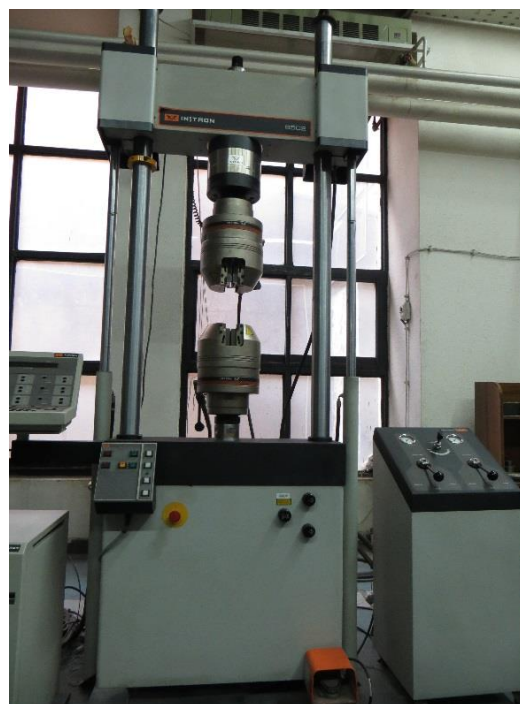
شکل ۷: تصویر دستگاه اینسترون ۸۵۰۲ دانشکده مکانیک دانشگاه تهران
