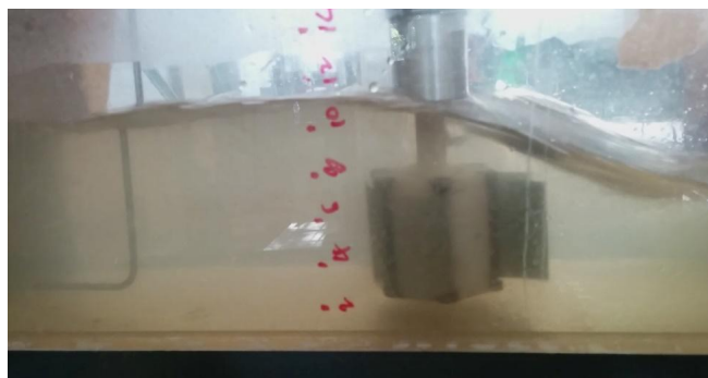
شکل ۳: تغییر شکل سطح آزاد در پائین دست مقطع توربین Fig. 3. Free surface deflection at the turbine downstream
