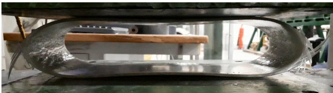
شکل ۱۸: وضعیت هندسی نمونه استوانه شماره ۳ در جابه‌جایی ۱۳۳ میلی‌متری
