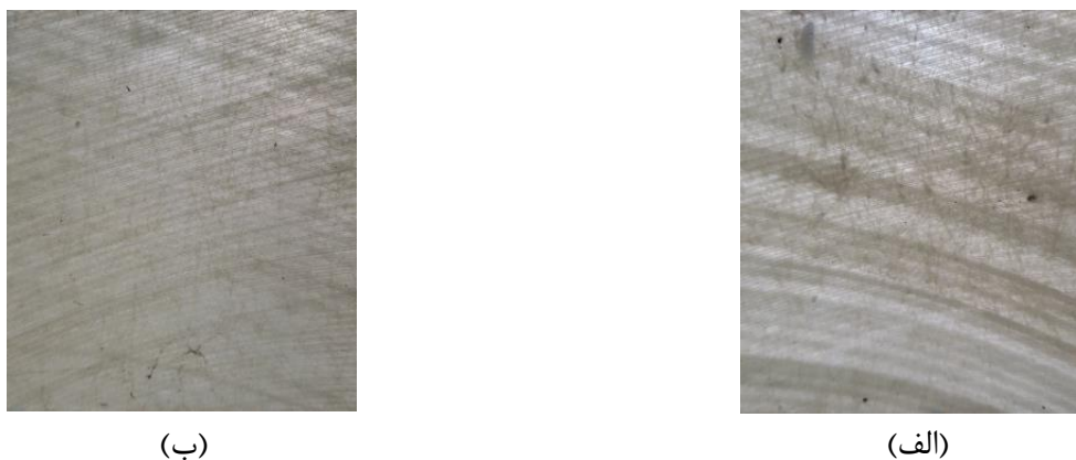
شکل ۲۲: تصاویر از وضعیت قرارگیری الیاف در نمونه استوانه‌ها (الف) نمونه شماره ۱ (ب) نمونه شماره ۳ Fig. 22: Images of the position of the fibers in the sample cylinders (a) Sample No. 1 (b) Sample No. 3
