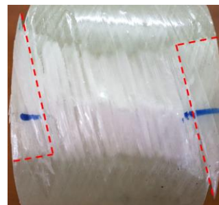
شکل ۱۶: سطح مثلثی شکل جدایش بین لایه‌های در سطح خارجی نمونه استوانه پس از اتمام آزمایش
