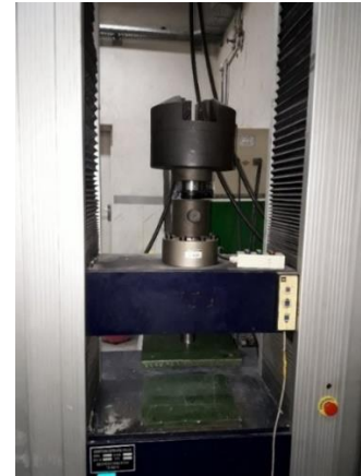
شکل ۵: تصویر دستگاه انجام آزمایش فشار بین دو صفحه صلب موازی Fig. 5: The image of the device performs the pressure test between two parallel rigid plates
