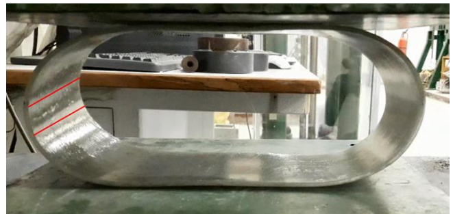
شکل ۱۴: ترک‌های اولیه ایجاد شده در سطح داخلی استوانه Fig. 14: Initial cracks formed on the inner surface of the cylinder
