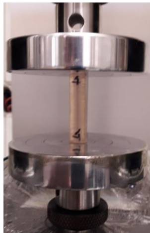
شکل ۳: نمونه مربوط به آزمایش فشار رزین پس از قرارگیری در دستگاه Fig. 3: Specimen of the resin pressure test after placement on the device
