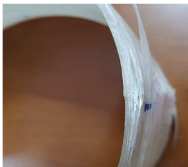
شکل ۱۷: تصویر جدایش بین لایه‌های در راستای ضخامت
