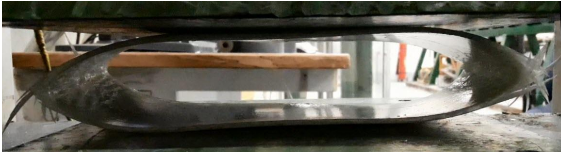
شکل ۱۹: وضعیت هندسی نمونه استوانه شماره ۳ در جابه‌جایی ۱۴۸ میلی‌متری Fig. 19: Geometric state of sample cylinder number 3 at 148 mm
