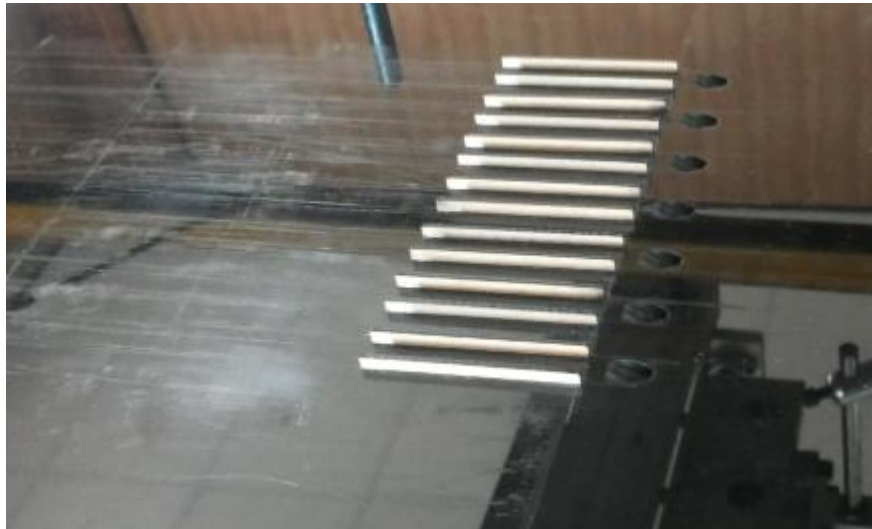
شکل ۳: نمایی از صفحه‌ی آزمون شامل هفت جت تزریق شده روی سطح و زائده‌های طولی مربوطه
