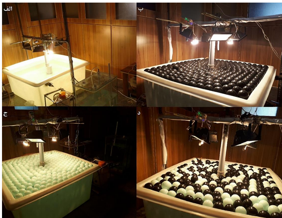
شکل ۳. تصویر واقعی تجهیزات آزمایشگاهی و حالت‌های مختلف پوشش‌دهی جهت ارزیابی نرخ کاهش تبخیر سطحی: الف) مخزن بدون پوشش ب) پوشش‌دهی با توپ‌های محافظ سیاه ج) پوشش‌دهی با توپ‌های محافظ سفید د) پوشش‌دهی ترکیبی
