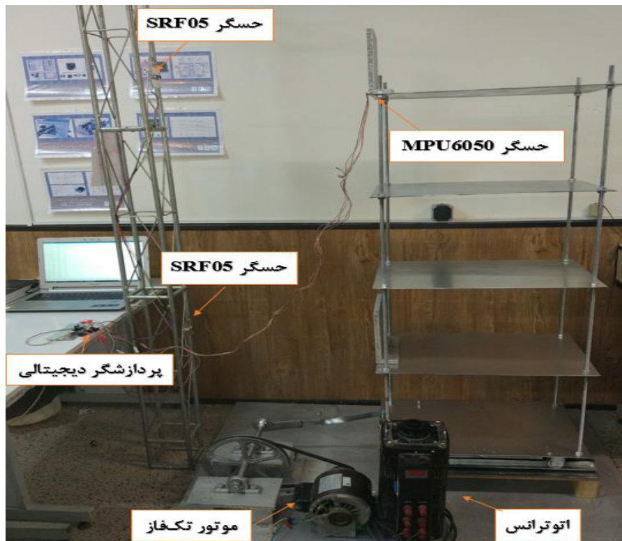
شکل ۳: نمایی از سازه ساخته شده در آزمایشگاه تحقیقاتی جهت شناسایی پارامترهای سازه
