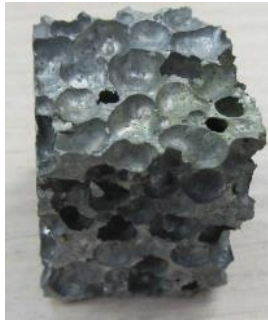
شکل ۱: نمونه مورد استفاده در تست بارگذاری فشار محوری Fig. 1. Uniaxial compression test specimen
