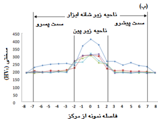
شکل ۸: نمودار توزیع سختی الف) آلیاژ آلومینیم ۵۰۵۲ ب) فولاد زنگ نزن آستنیتی ۳۰۴
