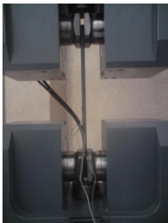
شکل (۱۷): نمونه قرار گرفته بین دو فک در دستگاه تست خستگی Zwick/Roell مدل Amsler HA250
