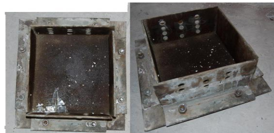
شکل ۶: نمائی از قالب فلزی
