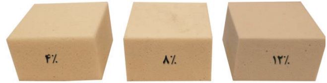
شکل ۴: نمونه‌های مختلف تهیه شده با نسبت چگالی‌های متفاوت برای انجام آزمایش‌های فشار تک‌محوری
