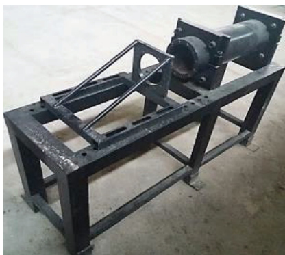
شکل ۶: نمایی از دستگاه لوله شاک انفجاری
