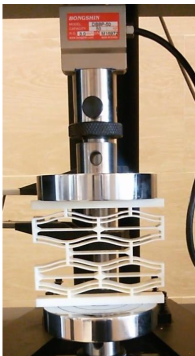
شکل ۲: دستگاه آزمایش برای بارگذاری شبه‌استاتیکی بر روی نمونه لانه‌زنبوری با سفتی منفی
