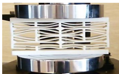
شکل ۸: مقایسه مرحله نهایی تراکم سازه لانه‌زنبوری با سفتی منفی و ضخامت ثابت به‌دست آمده از آزمایش تجربی و حل عددی
