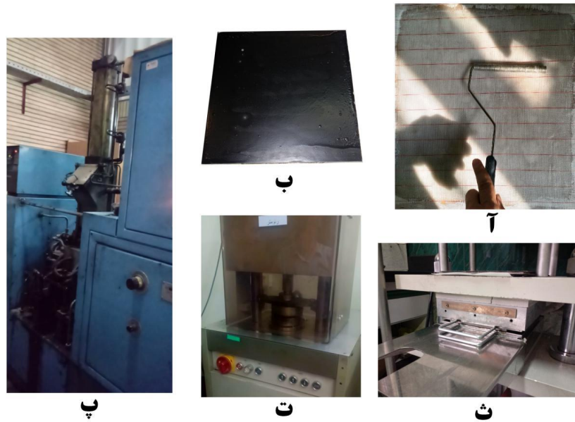
شکل ۲: فرایند ساخت تجربی نمونه‌ها، آ: ساخت کامپوزیت به روش لایه‌چینی دستی، ب: اعمال چسب کموزیل روی ورق آلومینیومی، پ: فراوری الاستومر به واسطه بنبوری آزمایشگاهی، ت: آزمایش رئومتر به منظور یافتن زمان و دمای پخت الاستومر، ث: پخت الاستومر و آلومینیوم توسط پرس داغ آزمایشگاهی
