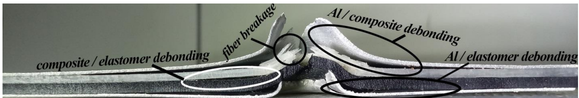
شکل ۵: مکانیزم‌های تخریب نمونه ساخته شده با چسب سیانوآکریلات بعد از آزمایش سرعت بالا
