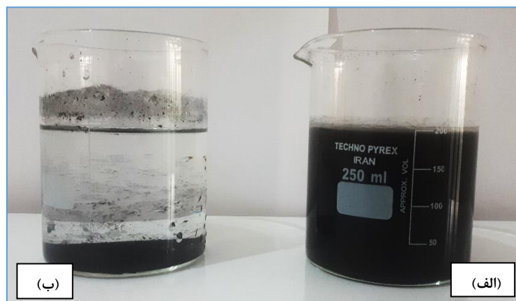
شکل ۳. نانو سیال کربن در دو حالت (الف) با سورفکتانت (ب) بدون سورفکتانت Fig. 3. Carbon nanofluid (a) with surfactant (b) without surfactant
