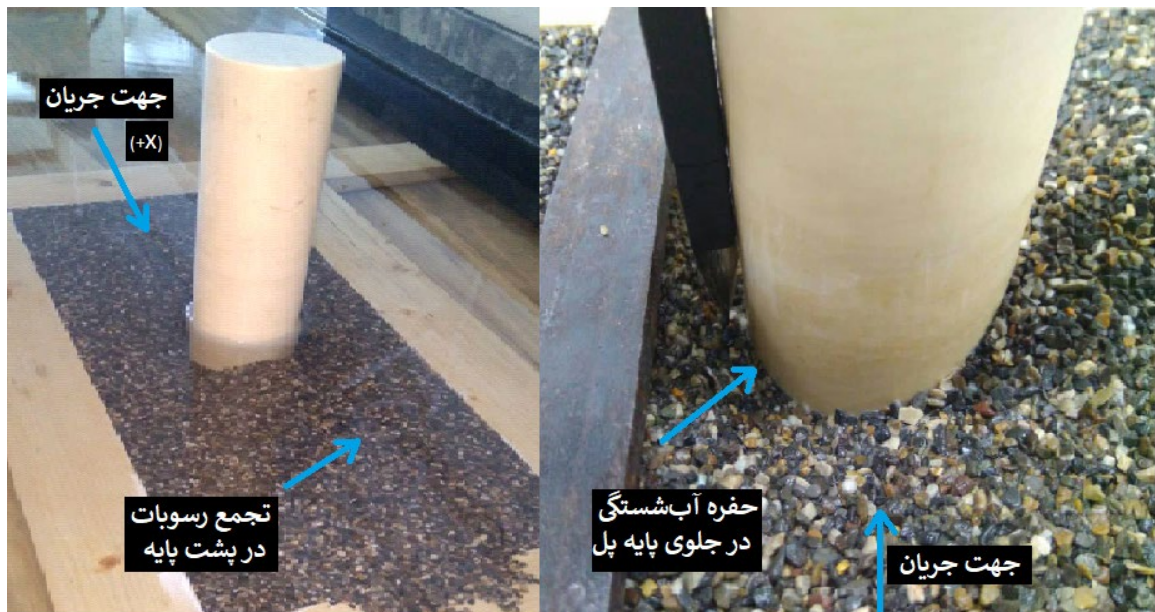
شکل ۶. حفره حاصل از آب‌شستگی در جلو پایه و انباشته شدن رسوب در پشت آن Fig. 6. Scour hole in front of the pier and backfilling on the back of the pier
