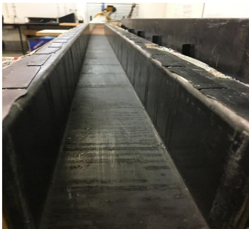
شکل ۴: محفظه آزمایش با مقطع مربع و جنس فولاد
