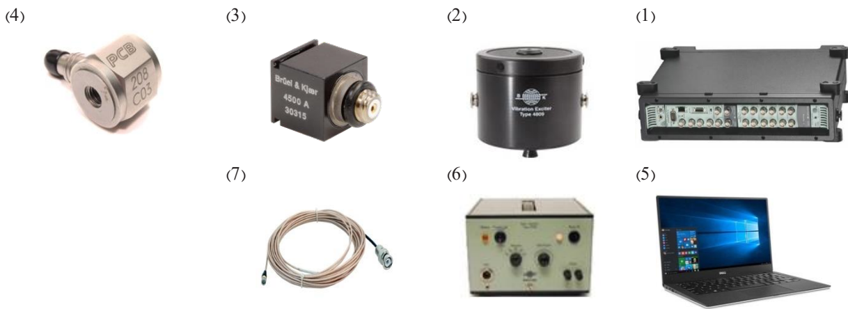
شکل ۳. تجهیزات آزمایشگاهی: (۱) سیستم جمع‌آوری داده پالس (۲) لرزاننده (۳) شتاب‌سنج (۴) نیروسنج (۵) لپ‌تاپ (۶) آمپلی‌فایر (۷) کابل‌های انتقال.
