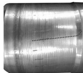
شکل (۱۳): جابجایی ماده در جهت محیطی [۱۱].
