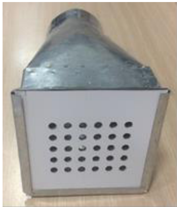
شکل ۲. دریچه ورود هوا به اتاقک آزمایش Fig. 2. Inlet air diffuser
