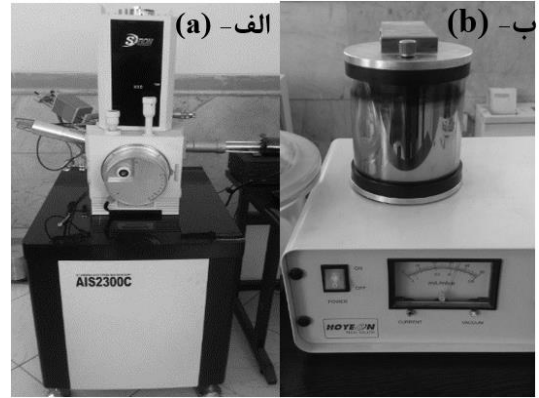
شکل ۳. (الف) دستگاه میکروسکوپ الکترونیکی (SEM) (ب) دستگاه پوشش دهی طلا
