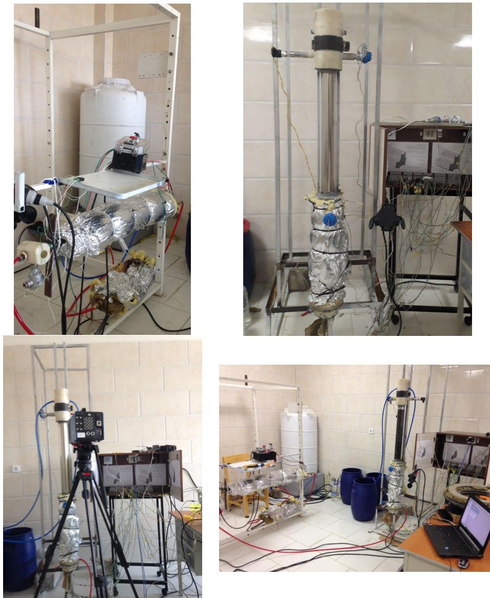
شکل ۱. ب) نمای کلی دستگاه آزمایش، تصویر بالا-چپ: مخازن ذخیره آب و پیش‌گرم، تصویر بالا راست: ست آب جریان جوش، تصویر پایین-چپ: محل قرارگیری دوربین و داده‌بردار، تصویر پایین-راست: کل مجموعه آزمایش
