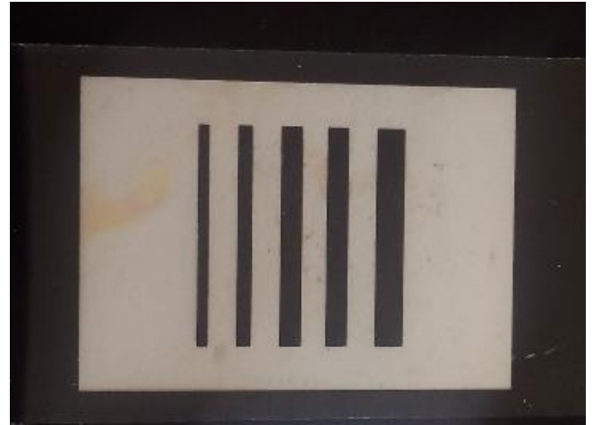
شکل ۸. تصویر فوتوپلاتر چاپ شده به منظور بررسی قطر میکروقطرات پلیمری و بررسی حساسیت قطرات به دما Fig.. 8. Image of printed photo plotter to check the diameter of polymer microparticles and to evaluate the temperature sensitivity of the droplets
