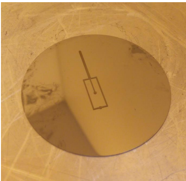
شکل ۳. قالب ساخته شده میکروکانال جریان متمرکزشونده بر روی ویفر سیلیکونی
