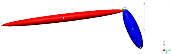
شکل ۱۲. پاندول دو جرمی شبیه‌سازی شده در محیط MSC Working Model
