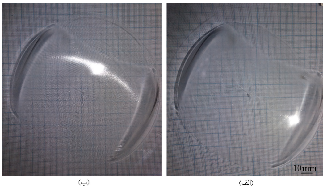
شکل ۱۱. مقایسه شفافیت محصول شکل‌دهی شده با استراتژی شطرنجی در حالت (الف) بدون دوران ابزار و (ب) سرعت دورانی ۱۰۰۰ rpm Fig. 11. Comparison of the transparency of the sample formed with the raster strategy. (a) without rotating tool and (b) rotational velocity 1000 rpm
