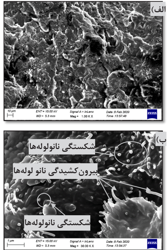
شکل ۱۲. تصاویر میکروسکوپ الکترونی روبشی سطوح شکست نمونه اپوکسی/نانو لوله کربنی در بزرگنمایی (الف) 10\ \mu\text{m} (ب) 1\ \mu\text{m} میکرومتر
