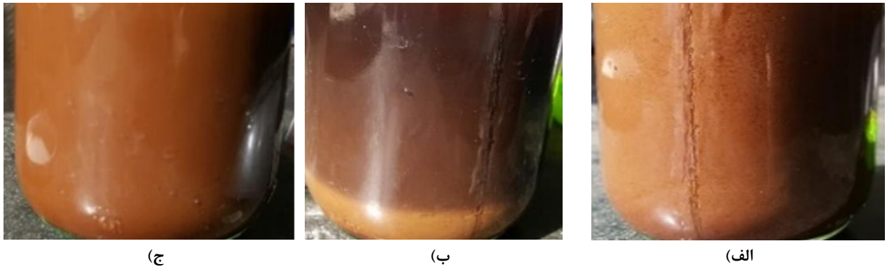
شکل ۶. فروسیال \phi = +0.5\% (الف) ۵ روز بعد از تولید (ب) ۷ ماه پس از تولید (ج) ۷ ماه پس از تولید و ۵ روز بعد از انجام اولتراسونیک
