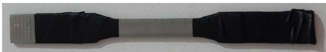
شکل ۳. نمونه آماده شده جهت انجام شارژ هیدروژنی. Fig. 3. Sample prepared for hydrogen charging.
