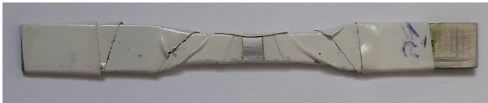
شکل ۵. نمونه آماده شده برای شارژ و دشارژ هیدروژنی. Fig. 5. Sample prepared for hydrogen charging and discharging.
