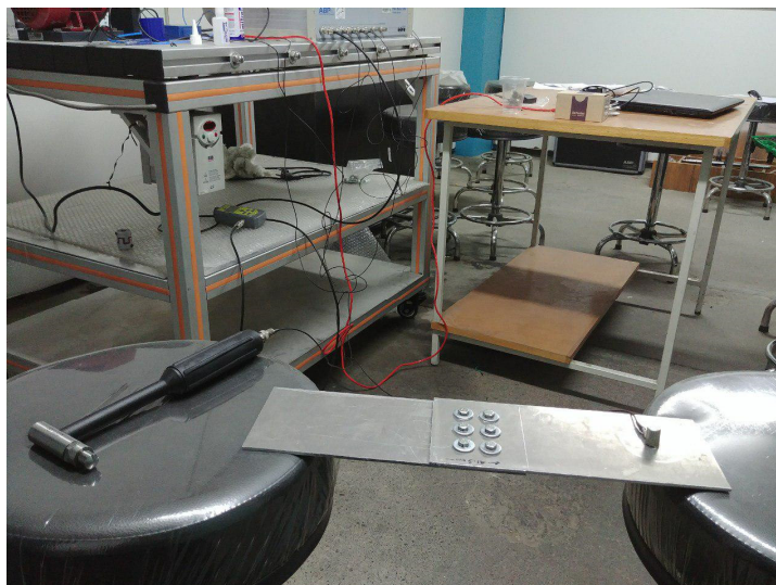
شکل ۳. پیکربندی انجام تست تجربی آنالیز مودال اتصال تک لپه پیچی Fig. 3. Configuration of experimental test analysis of single-lap bolt joint
