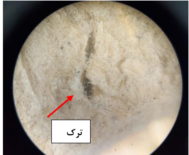
شکل ۱۱. ناحیه تخریب شده نمونه مقوایی تحت کشش
