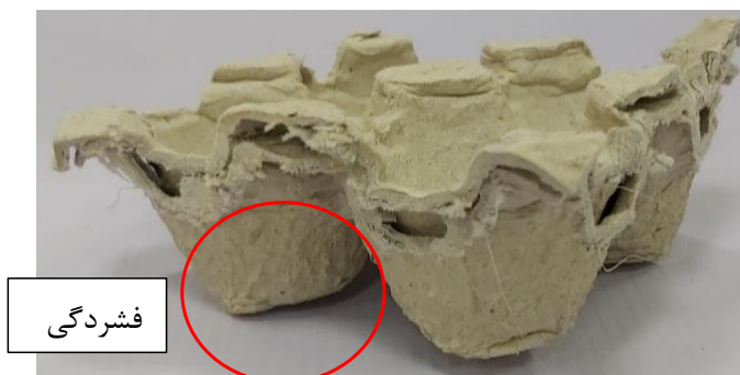
شکل ۱۹. هسته سری بعد از بارگذاری، الف) فشرده‌گی ناحیه بالایی شانه ب) فشرده‌گی ناحیه پایینی شانه
