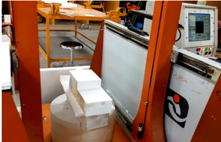
شکل ۳. برش فوم‌های پلی استایرن با دستگاه سیم داغ Hitachi
