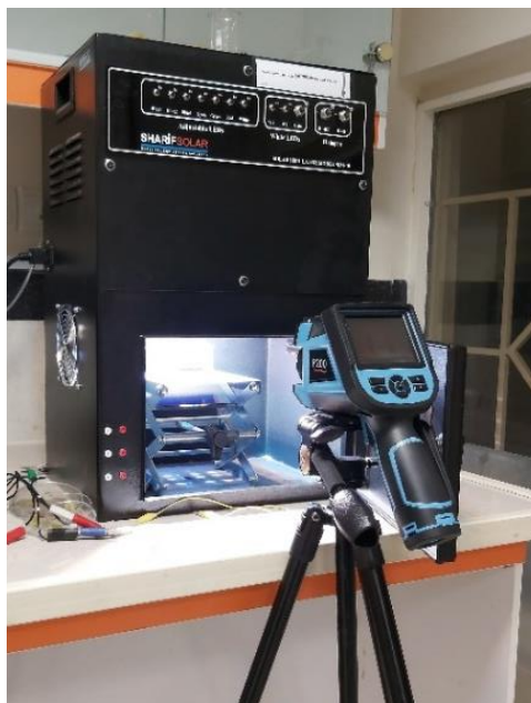
شکل ۴. شبیه‌ساز خورشیدی و دوربین ترموگرافی، آزمایشگاه نانو‌اپتوالکترونیک دانشگاه تربیت مدرس
