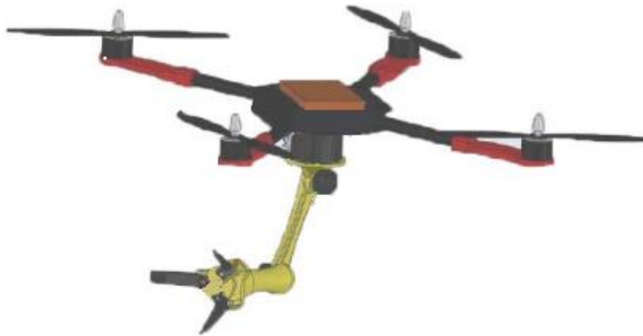
شکل ۲. نمایی از کوادروتور به همراه بازو [۸]
